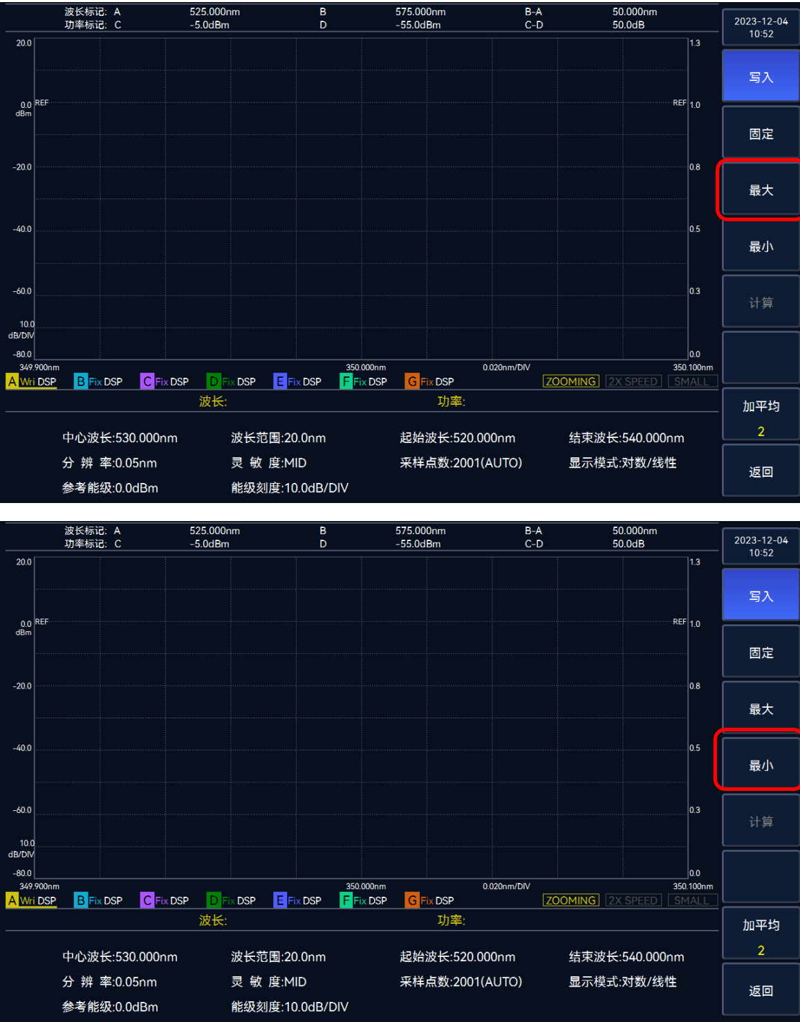
图 3.40 曲线保持条件示意图
